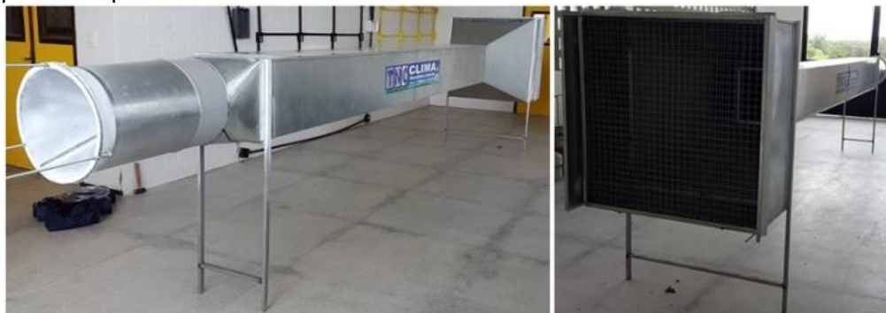
Figura 2. Vista do túnel de vento reduzido antes da instrumentação e acoplamento das placas evaporativas e sistema de molhamento
