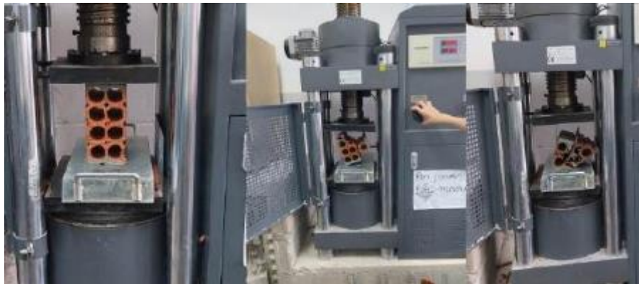
Figura 11- Segundo ensaio de compressão para validação dos resultados no Laboratório de Materiais de Construção IFSertão Campus Salgueiro.
