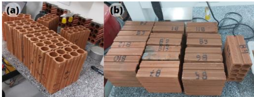
Figura 4- Identificação dos blocos relacionando as empresas fabricantes: (a) Identificação para empresa C; (b) Identificação para empresa B.
